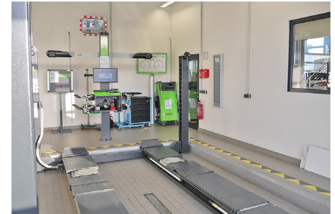
Modern ausgestattete Direktannahme. Die Bosch-Tester lassen sich über die asanetwork-Schnittstelle mit Loco-Soft vernetzen. Messdaten werden direkt beim Kunden gespeichert.
